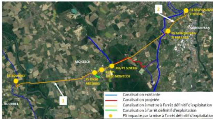
1 : Canalisation DN150/125/100 BOURRET – MONTEBAN ZI PARAGES - 2 : Canalisation DN100/125/150 MONTEBAN ZI PARAGES – MONTEBAN STATION
